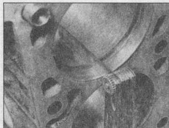
14.26 Проверка зазора замка поршневого кольца
