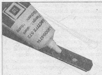
10.18 Нанесите герметик на пластину фиксатора
