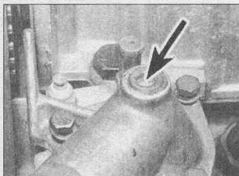
23.14 Дренажный штуцер на коленчатом патрубке термостата
