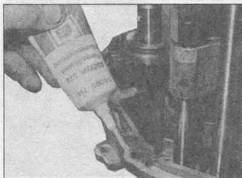
10.20 Нанесите герметик на задний картер
