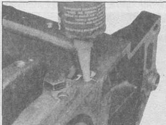
**16.9** Заполнение канавки уплотнителем
