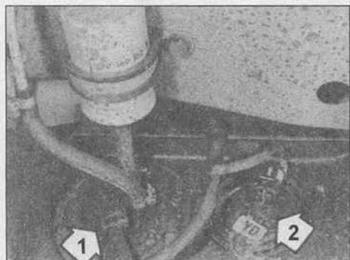
6.1А Топливный насос в баке (1) и датчик уровня топлива (2)
