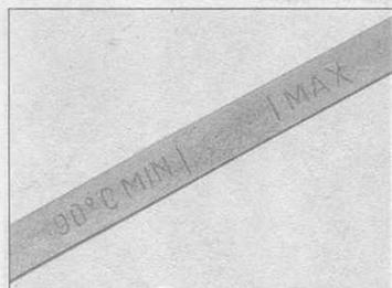
2.10 Метки на шупе измерения уровня жидкости автоматической трансмиссии
