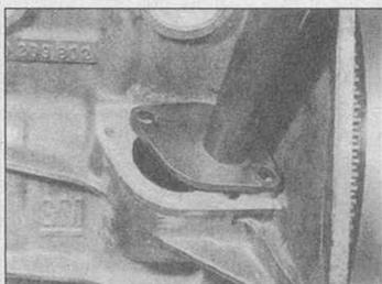
9.22А Нижний фланец трубы вентиляции мотора ...
