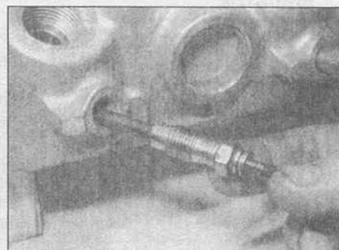
22.5 ... затем снимите свечи
