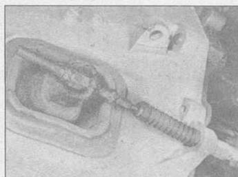
2.5В На некоторых моделях гайка регулировки действует непосредственно на рычаг
