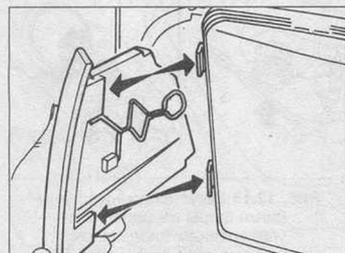
Рис. 12.11 Расположение стопоров лампы передних указателей поворотов (Глава 28)
