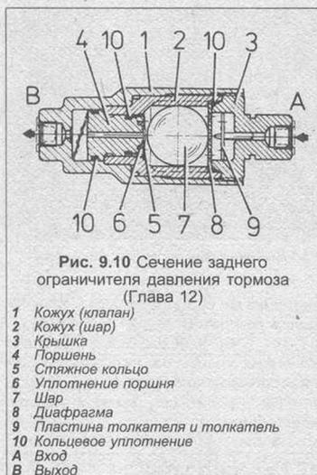
Рис. 9.10 Сечение заднего ограничителя давления тормоза (Глава 12)
