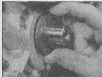
16.26А Использование целлюлоида как направл. втулки при установке переднего сальника коленвала
