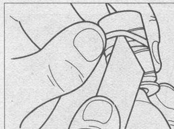
Рис. 9.2 Снятие уплотнения поршня переднего тормозного суппорта (Глава 5)
