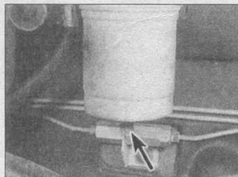
7.2 Сливная пробка топливного фильтра (отмечена стрелкой)
