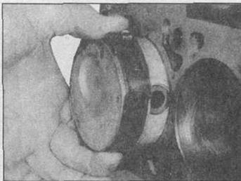
16.17В Установка поршня (со съемником поршневых колец) в цилиндр
