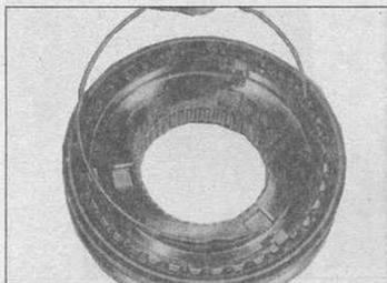
6.18 Снятие пружины с синхронизатора
