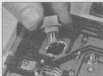
27.43 Снимите держатель лампы из приборной панели ...
