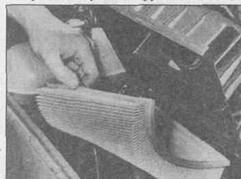
4.9 Снятие фильтрующего элемента воздушного фильтра
