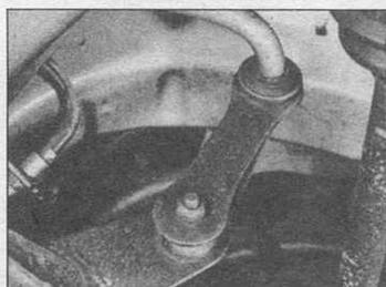
15.3 Задняя связующая штанга стабилизаторов поперечной устойчивости
