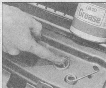
2.3 Смазывание замка капота
