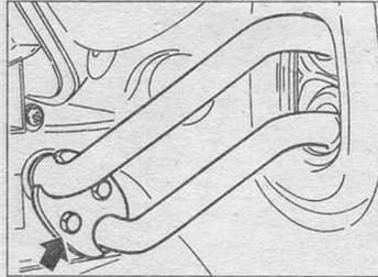
Рис. 11.14 Фиксатор трубки отопительного прибора (Глава 33)
