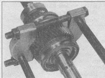
6.9 Снятие синхронизатора 1/2 передач и шестерни 1-ой передачи
