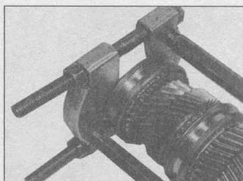
6.35B Установка синхронизатора 3/4 передач
